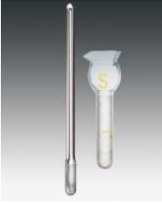
Gefäße aus Borosilikatglas, mit gitterartigen Einkerbungen, komplett mit eingeschliffenem Glaskolben
