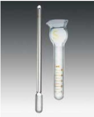
Gefäße aus Borosilikatglas, ohne gitterartige Einkerbungen, komplett mit eingeschliffenem Glaskolben
