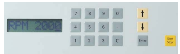
Fig. 6: Champ de commande avec clavier à membrane du Mikro-Dismembrator U
