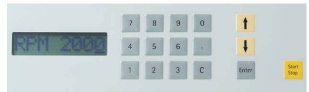
Abb. 6: Bedienfeld mit Folientastatur des Mikro-Dismembrator U
